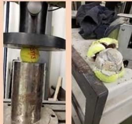
Participé además en la ejecución de ensayos a compresión de las pelotas de tenis rellenas de mortero.
