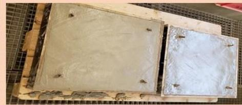
Participé en la elaboración de los componentes de la propuesta de sistema de aislamiento sísmico de bajo costo que utiliza pelotas de tenis recicladas rellenas de mortero de cemento, que se deslizan sobre platos de hormigón con superficies planas o cóncavas.
